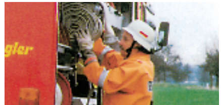
Schlecht verstaute Ladung und ein schräg abgestelltes Fahrzeug: da hat man schnell eine Schlauchkupplung im Gesicht!
